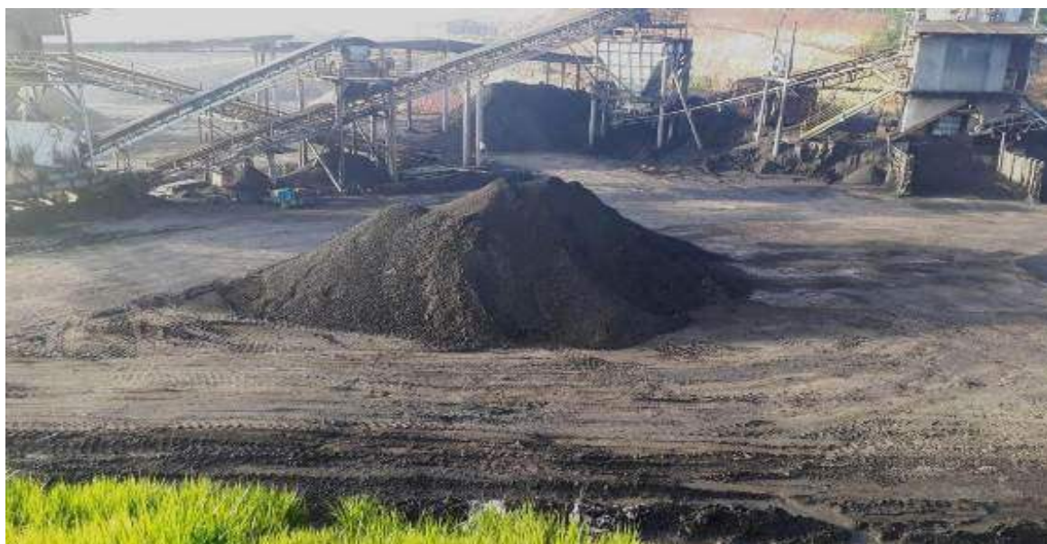
Figura 19: Finos do aerosseparador estocados no pátio da usina aguardando transferência para a Usina Lageado.
