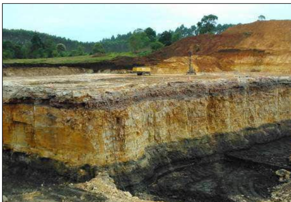
Figura 61: Aspectos da frente F em 2015. Na base do pacote arenoso ocorre a camada Barro Branco.
