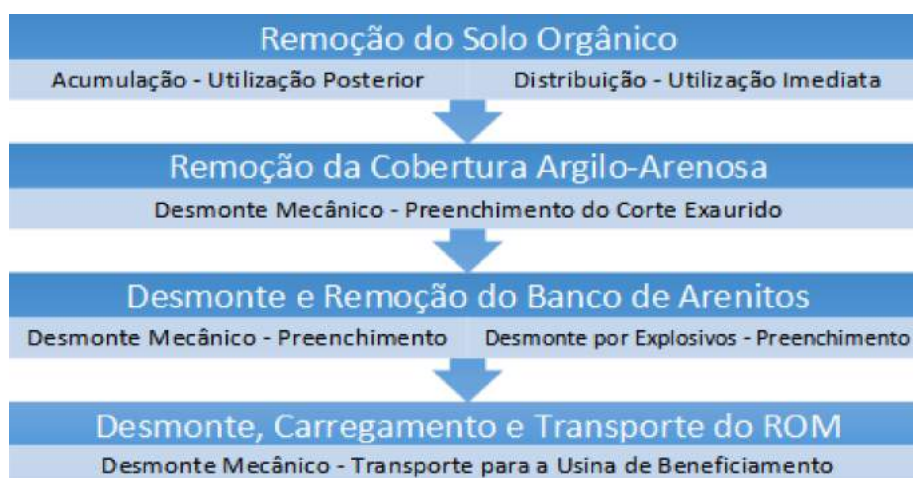
Figura 5: Fluxograma do ciclo de operação nas frentes de lavra da Mina Santana Céu Aberto.
