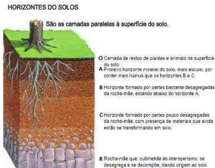
Figura 21: Perfil esquemático dos horizontes dos solos.
