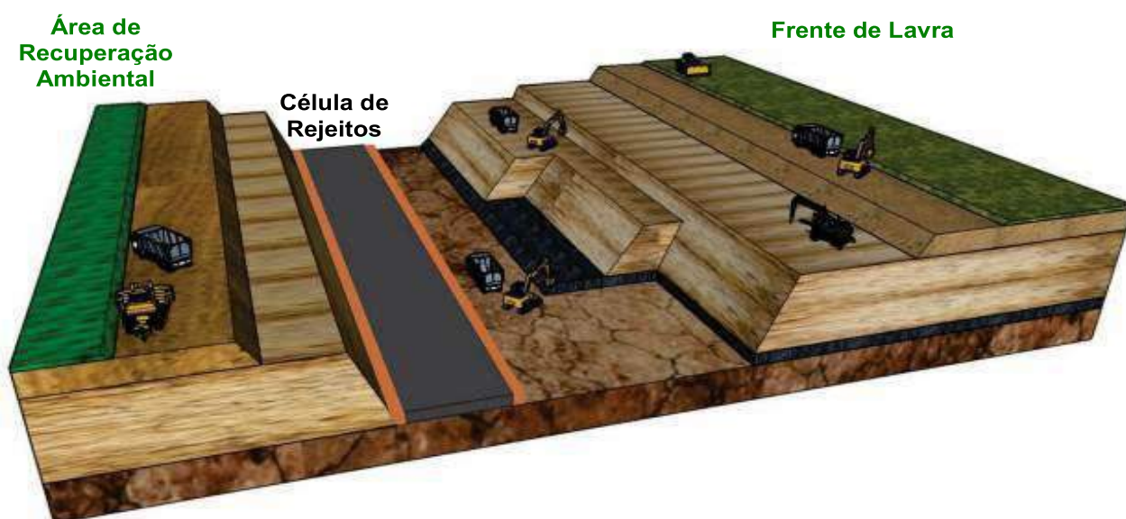
Figura 4: Esquema de lavra a céu aberto pelo método denominado “stripping mining”, com recuperação ambiental simultânea à lavra.
