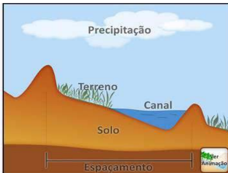
Figura 22: Croqui de terreno com terraços construídos. Fonte: programa Terraço 4.1 (GPRH, 2009).
