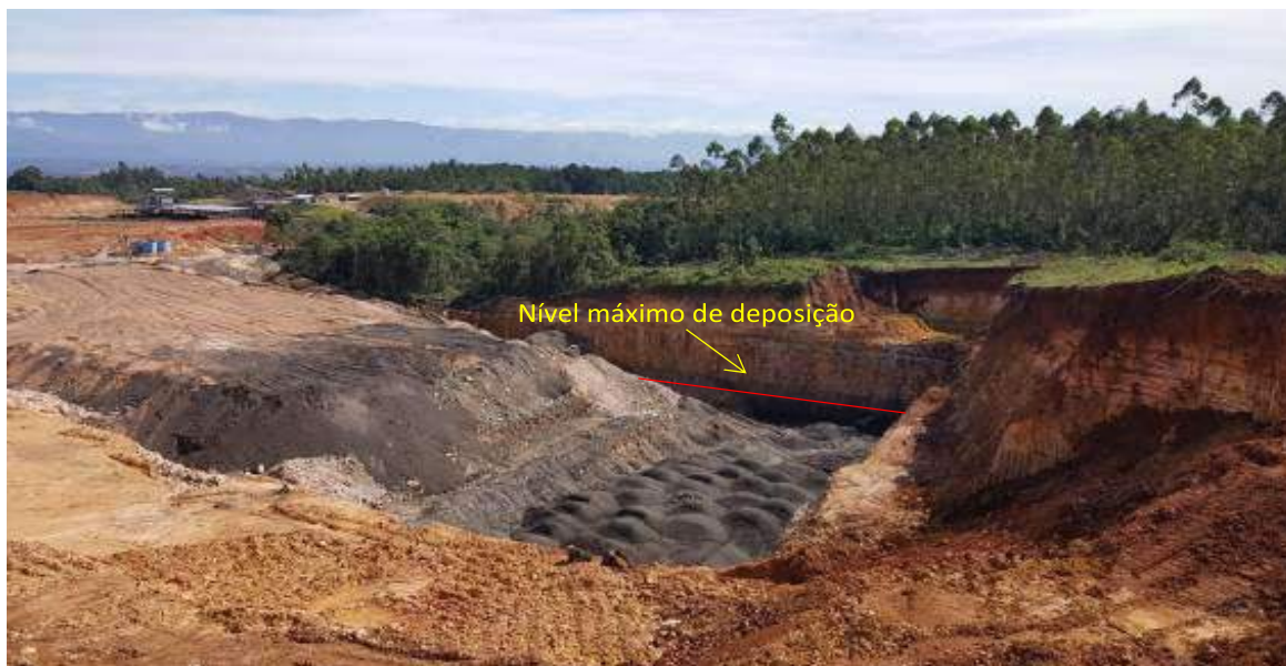
Figura 17: Deposição de rejeitos do aerosseparador no interior da cava com indicação do nível máximo de deposição.
